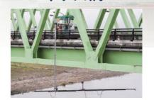
斜材により橋梁点検車デッキの 挿入が困難な箇所も挿入すること ができるため点検が可能です。
