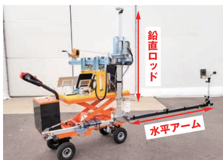
水平アーム: 1.8m / 3.0m 鉛直ロッド: 1.5~7.5m
