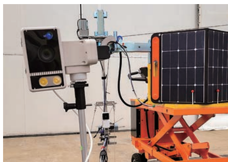
点検メインカメラ (日立産業制御ソリューションズ社製)
