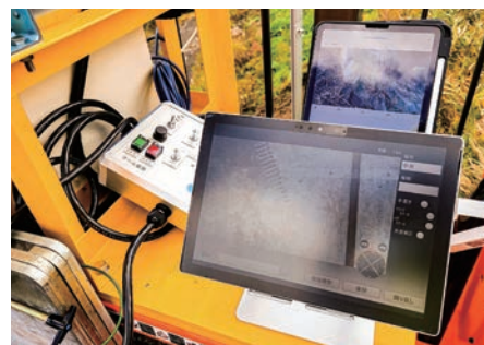
タッチパネル式 カメラ操作盤
